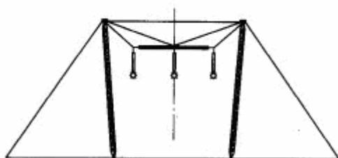
图 12-18 1150kV 悬索直线塔
