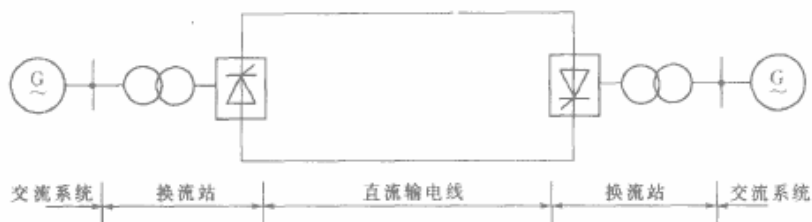
图 1-5 直流输电系统示意图
